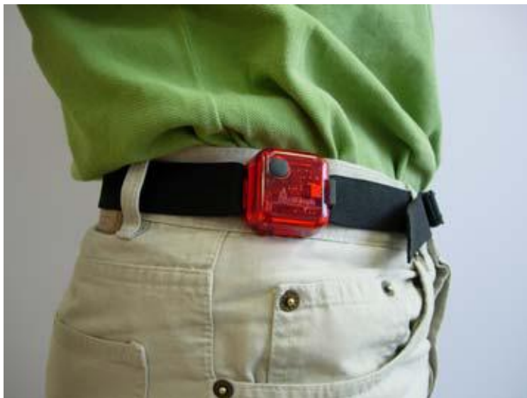
Figur 3.8 Actigraph akselrometeret og plassering på høgje hofte.
