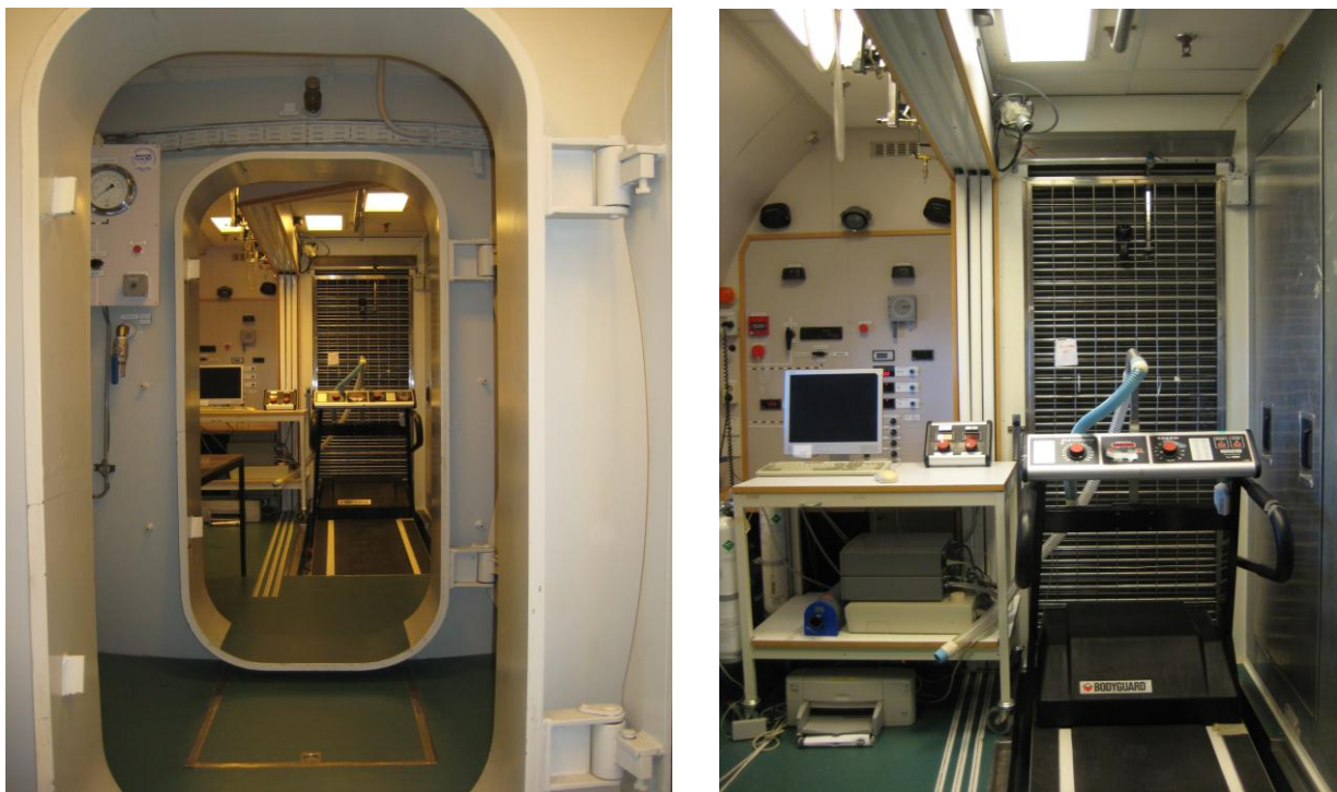
Figur 3.7. Lavtrykkskammer ved fysiologisk laboratorium, Norges idrettshøgskole, Oslo.
