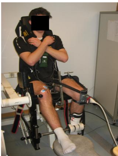
Figur 10 Beskriver oppsettet for måling av seneforlengelse og økende kraft.
