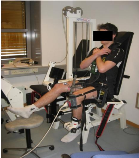
Figur 4 Måling av patellarsenens deformasjon og dreiemoment i en isometriske kneekstensjonsstol, der en ultralydprobe er godt festet over patellarsenen.
