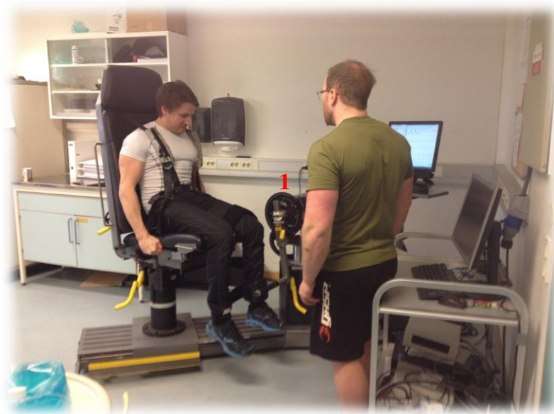
Figur 3.3 Dynamometer benyttet til isokinetiske -og isometriske styrketester. 1: Dynamometer.
