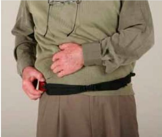
Figur 20. Angir riktig plassering av akselerometeret (Hentet fra (Helsedirektoratet, 2009))
