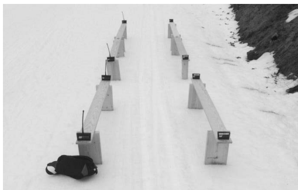
Figur 3.4: Oppsett av friksjonstesten. Plankene står 30 cm over bakken slik at leggen bryter fotocellene.
