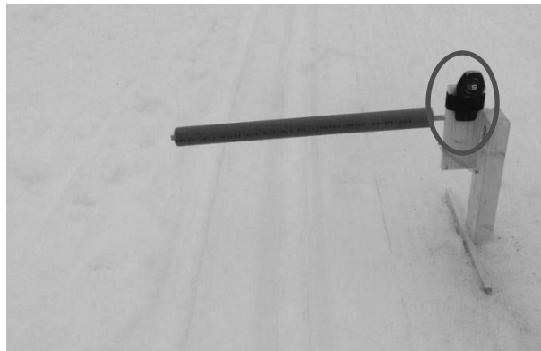
Figur 3.3: Passeringspinnens plassering i forhold til sporet. Microsensorenheten er markert med en ring.
