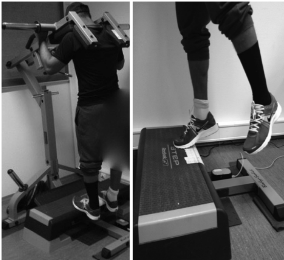
Figur 4: Konsentrisk powertest. Med bruk av lineær encoder hvor kraft og tid blir målt.
