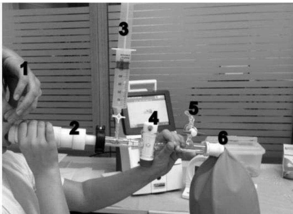
Figur 3.4.1: Spirometeret som ble brukt til å måle hemoglobinmasse. 1. Assistent som holder for nesen, 2. Kammer for soda lime, 3. Plastspøyte med CO-gass, 4. Stoppekran, 5. Stoppekran, 6. Anestetisk bag. Bildet er hentet med tillatelse fra Aaeng (2014).
