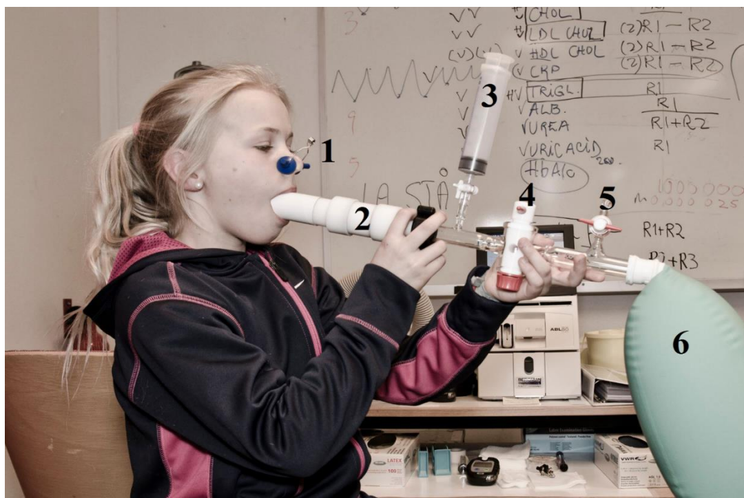
Figur 3.2: Spirometer til «the optimized CO-rebreathing method». Neseclupe (1), kammer for sodalime (2), CO-gassprøyte (3), stoppekran for stenging av O 2 (4), stoppekran for fylling av O 2 (5) og anestetisk bag (6).
