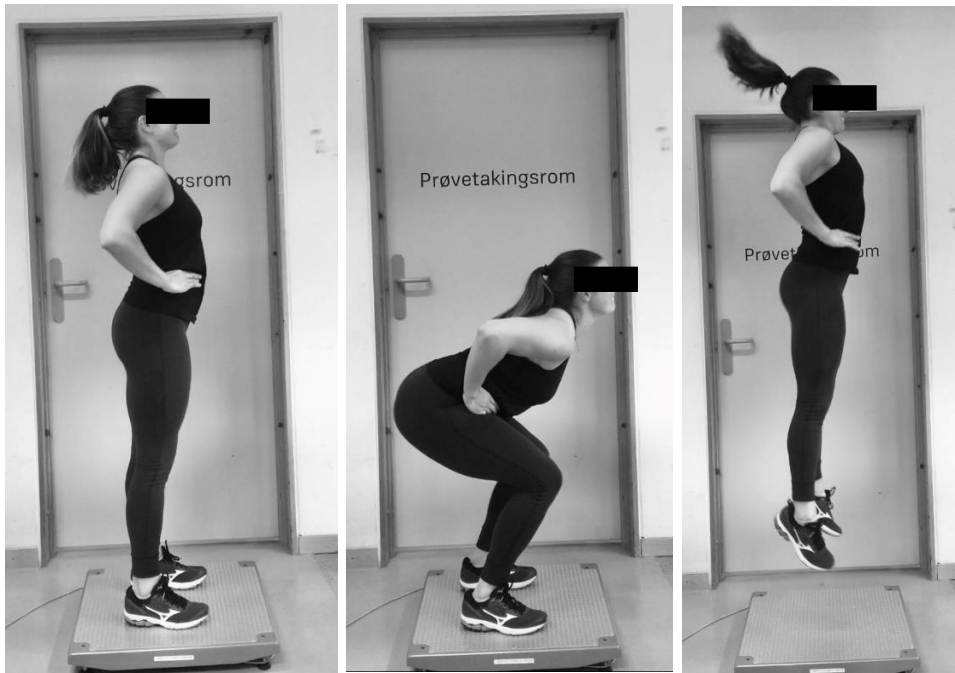
Figur 7: Bilder av utførelse av svikhopp på kraftplattform.
