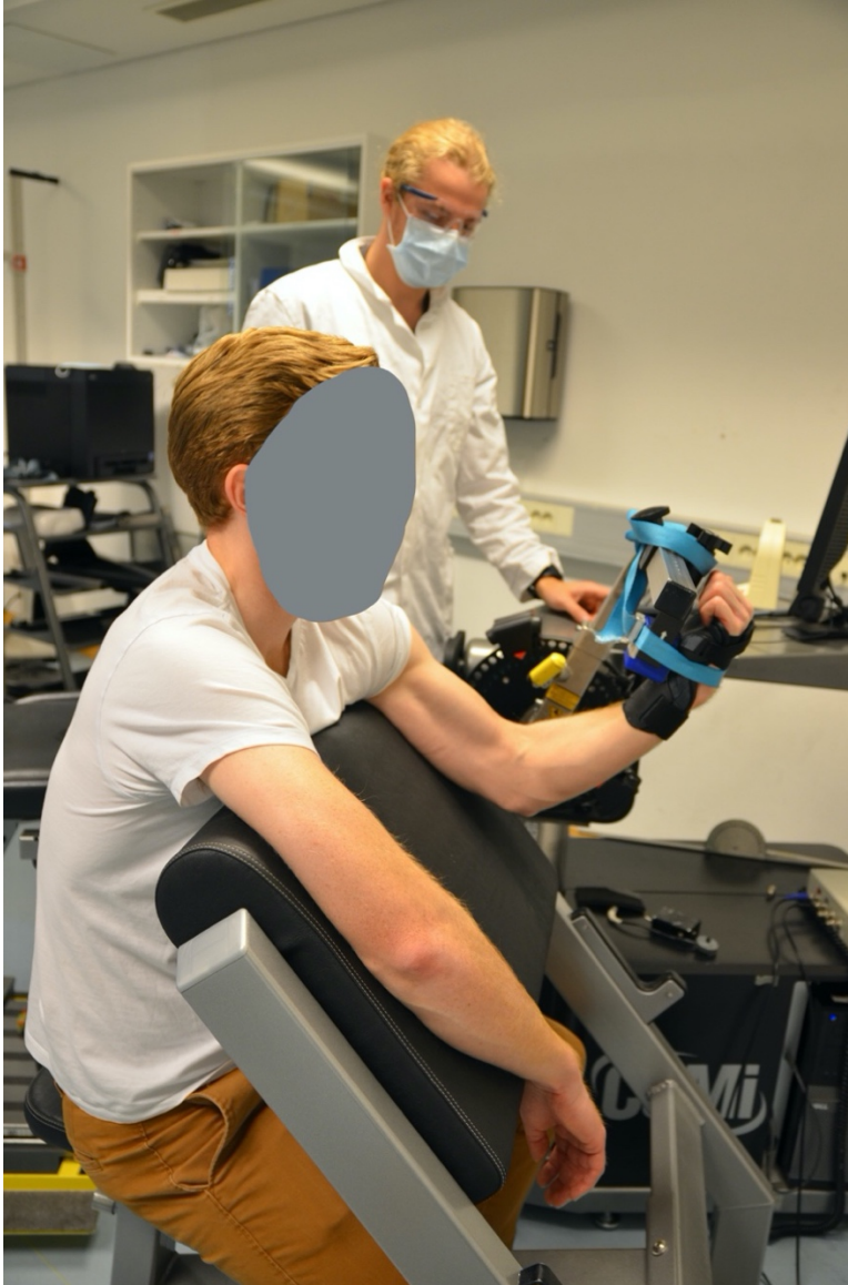
Figur 3.2: Bilde av forsøksperson festet på dynamometeret med håndleddsstøtse som utfører maksimalt eksentrisk arbeid.
