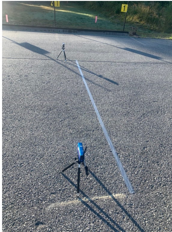
Figur 3.1: Startoppstilling på 40 meter hurtighetstest. Høyde på fotocellene: 30 cm. Avstand fra fotoceller til startstrek (markert med sølv tape): 50 cm.
