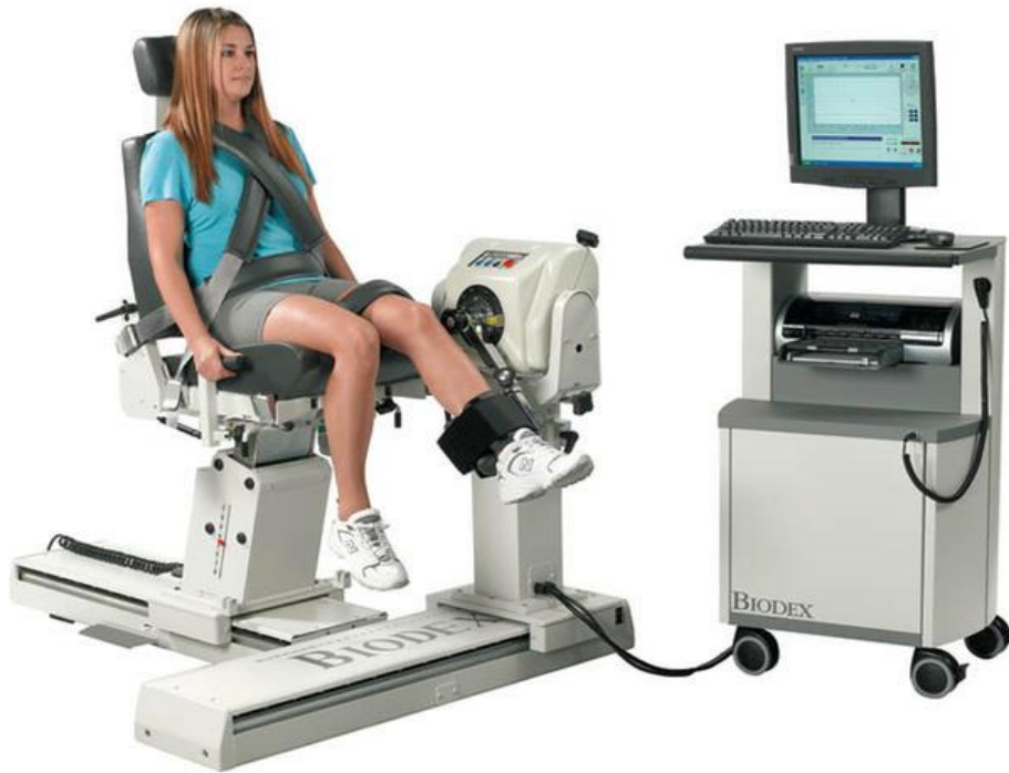
Figur 8: Testing av isokinetisk styrke i Biodex. «Armen» er stangen som festes til deltakerens fot. Hentet fra ( www.fysio.cz , 2013). Copyright Fysiomed CS, 2013.
