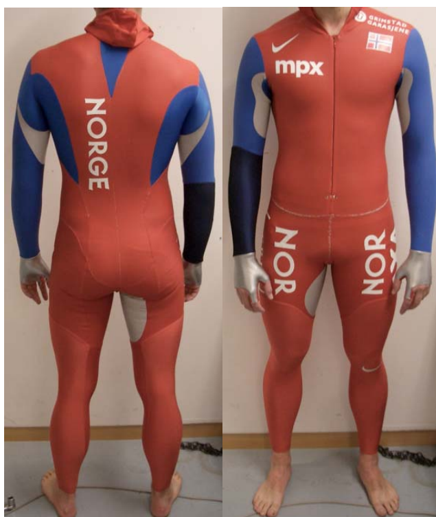
Bilde 2. Nike drakta som vart nytta i studien. Det raude stoffet på overkroppen og til midten av låret er gummiert (elastisk) materiale.
