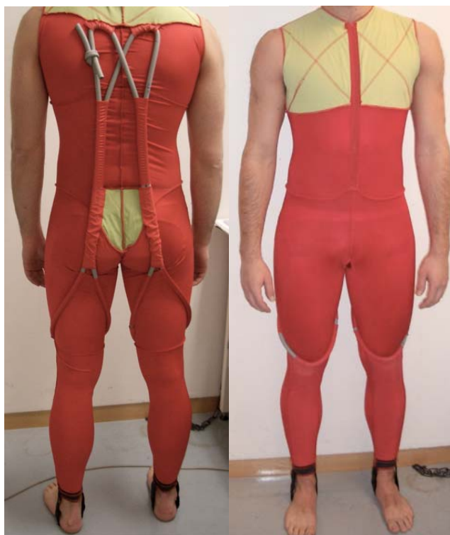
Bilde 3. Den konstruerte drakta er her tatt på vrang for å vise korleis strikkane er sydd inn i drakta. Det grøne stoffet er meint å gi friksjon mot huden. Stoffet på framsida av leggen er uelastisk og vert festa under hælen med ein lang borrelås.
