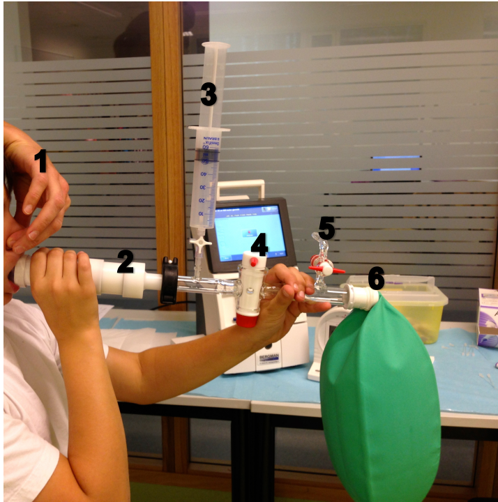
Figur 3.1: Viser utstyr til måling av Hb-masse ved hjelp av "The optimised CO-rebreathing" metoden. 1, Assisten som holder for nesen, 2, kammer for sodalime, 3, gass-sprøyte, 4, stoppekran for stenging av oksygen, 5, stoppekran for fylling av oksygen, og 6, 3L anestetisk bag.
