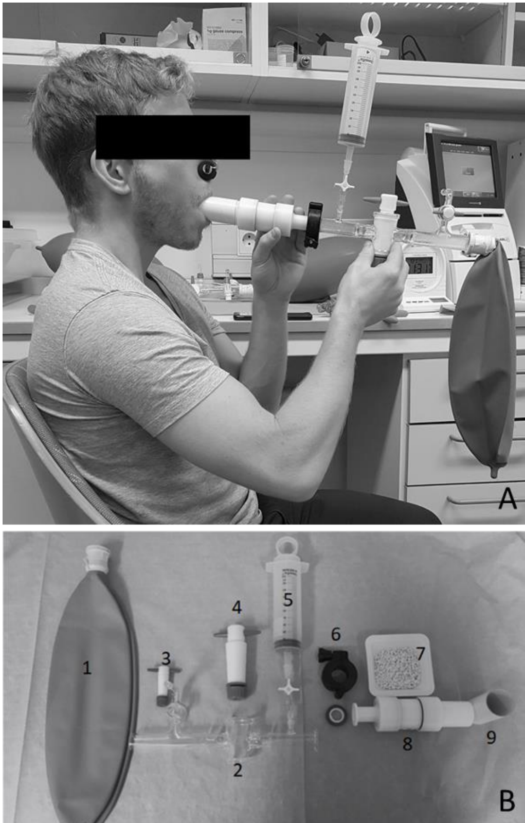
Figur 3.3. 3.3A viser en forsøksperson som gjennomfører optCO. 3.3B viser et oversiktsbilde av delene som tilhører spirometeret i optCO. I kammeret (nr. 8) ligger det soda lime (nr. 7) sammen med virus- og bakteriefilter samt sperrefilter til soda lime (ikke vist på bildet). Nr 6. er et tetningslås mellom spirometer og kammer.
