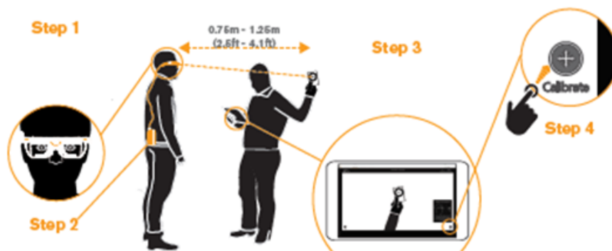
Figur 2: En illustrasjon av kalibreringsprosessen som ble brukt til å kalibrere eye trackeren Tobii Pro Glasses 2 på deltakerne. Note. Fra Quick Start Guide Tobii Glasses 2 (s. 4), av Tobii Pro, Tobii AB (publ), Karlsrovägen 2D, S-182 53, Danderyd, Sweden. Gjengitt med tillatelse, se vedlegg F.
