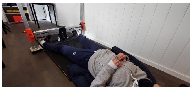
Figur 14: Illustrasjon av testutførelse med ForceFrame (Vald Performance, Albion, Australia) med lang vektarm hvor kraftcellene er plassert 3cm distalt for de mediale malleoler. Her fra testing i 15° hofteabduksjon. Prosjektets egne bilder.
