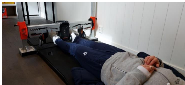
Figur 9: Figuren viser måleinstrumentet ForceFrame (Vald Performance, Albion, Australia) og hvordan ankene er plassert med kraftcellene 3cm distalt for de mediale malleoler. Her fra testing i 0° hofteabduksjon. Prosjektets egne bilder.
